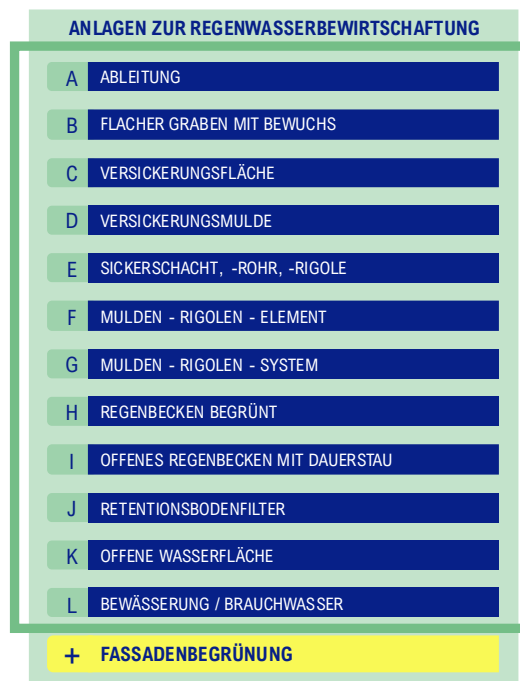
Abbildung 20: Übersicht der 12 Anlagen zur Regenwasserbewirtschaftung, gekennzeichnet mit den Buchstaben A bis L
